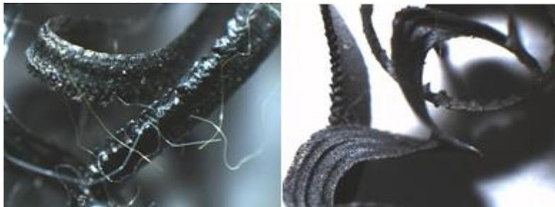
**Figura 4:** Observación microscópica fibras recicladas (izquierda X2,5) (derecha X1,6)
