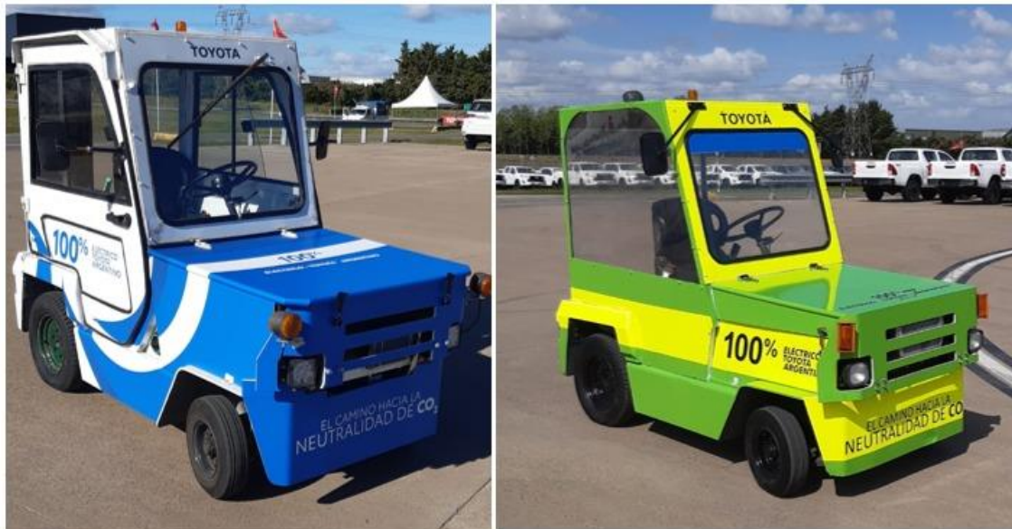
Foto de los tractores 2TG10 ya convertidos a eléctricos.
