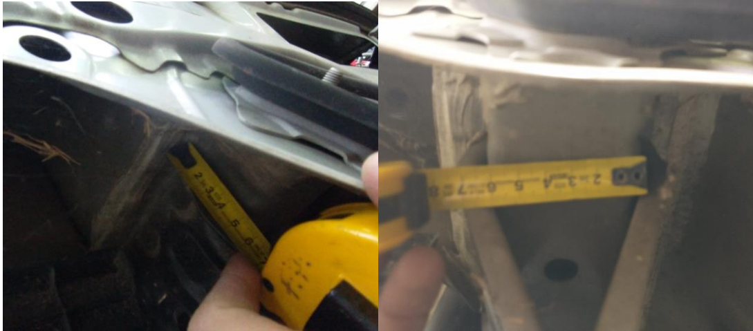
Fotos: Alto y ancho de la estructura inferior de la parte trasera del vehículo.
