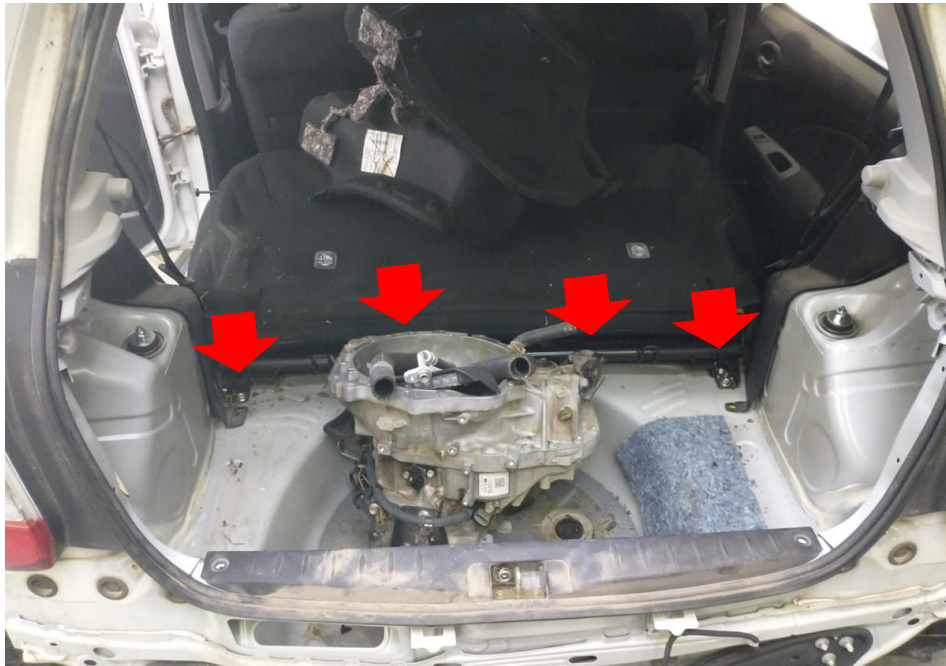
Foto: Vista superior de la parte trasera del vehículo. Las flechas indican donde se encuentran las sujeciones del respaldo del asiento trasero. Los largueros se encuentran debajo del piso del baúl
