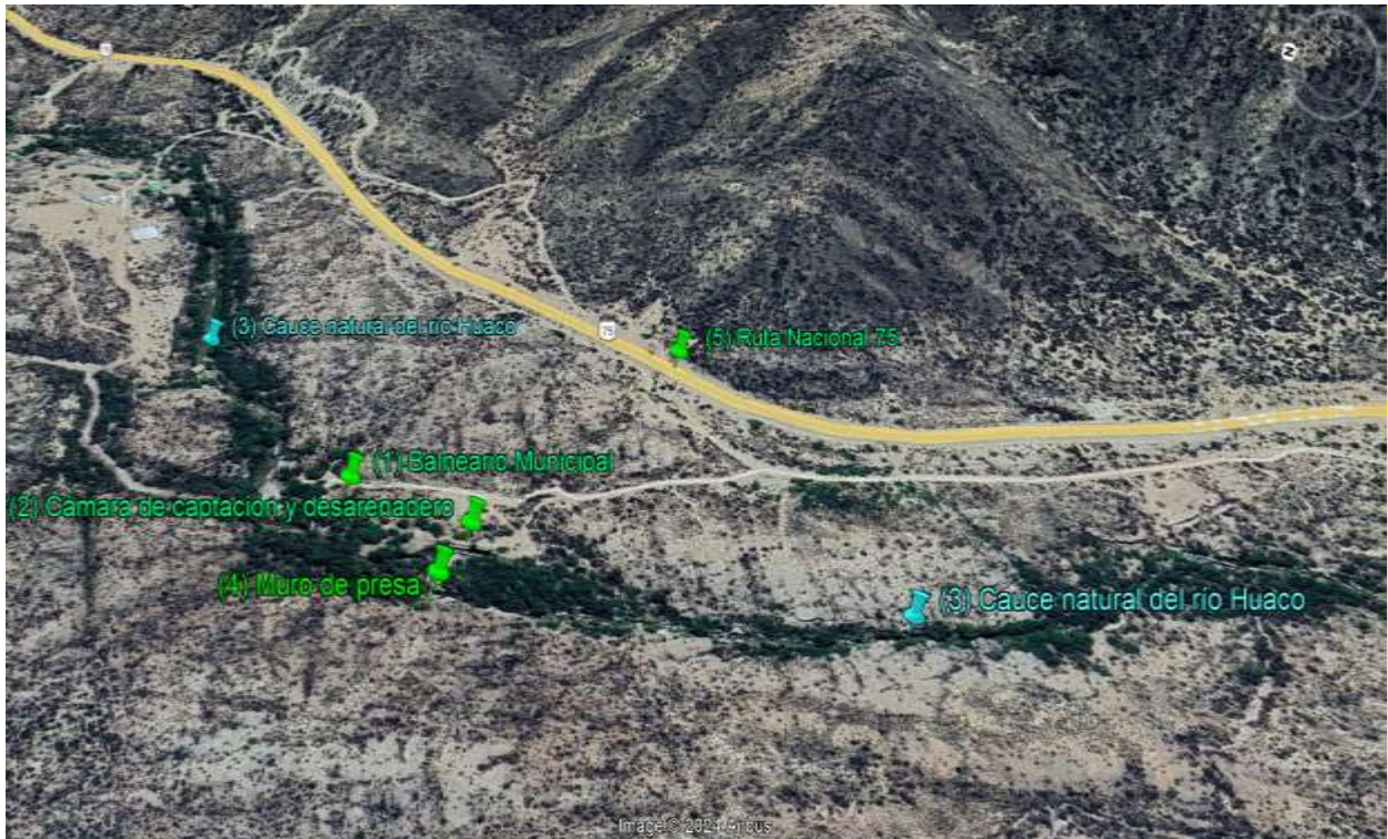
Figura 14 A: Vista satelital del Río Huaco y Azud Paso de Los Sauces. (1) Bañero Municipal; (2) Cámara de captación de agua y desarenadero; (3) Cauce natural del Río Huaco; (4) Muro de presa; (5) Ruta Nacional 75. Adaptado de Google Earth Pro (2024).
