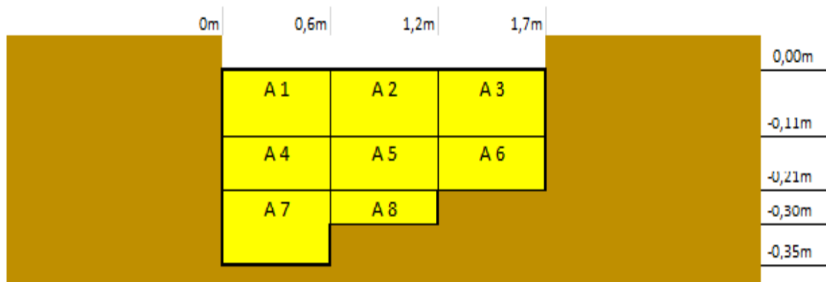
Figura 31: Sección transversal del Río Huaco para el 4° aforo, subdivisión de áreas " A_i ". 22 de septiembre del año 2022.
