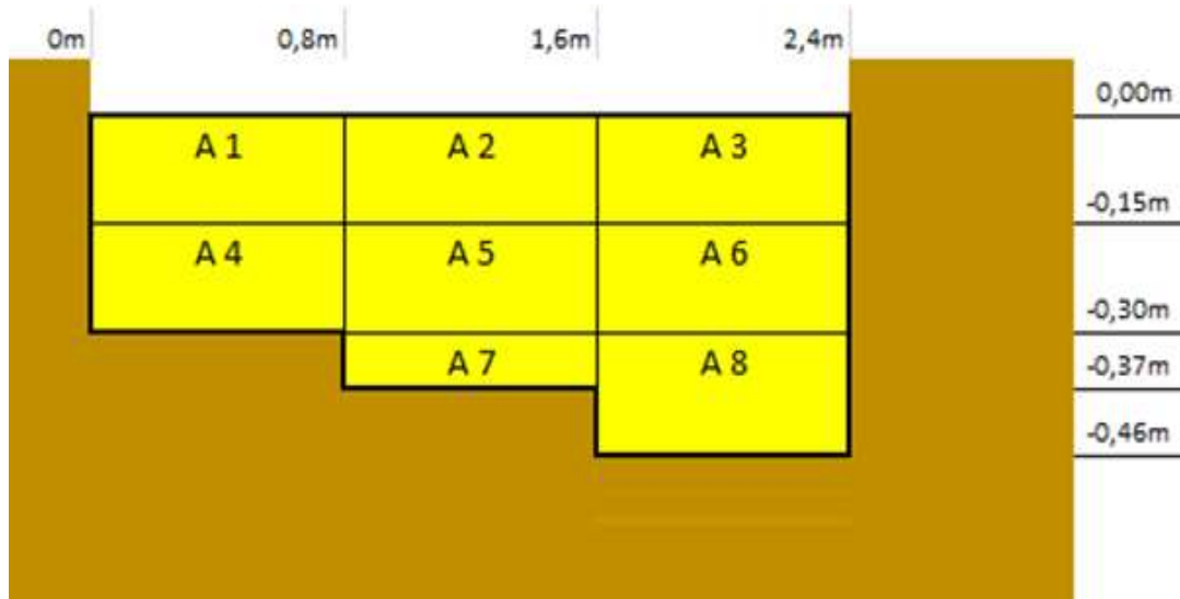
Figura 35: Sección transversal del Río Huaco para el 6° aforo, subdivisión de áreas “A i ”. 21 de diciembre del año 2022.
