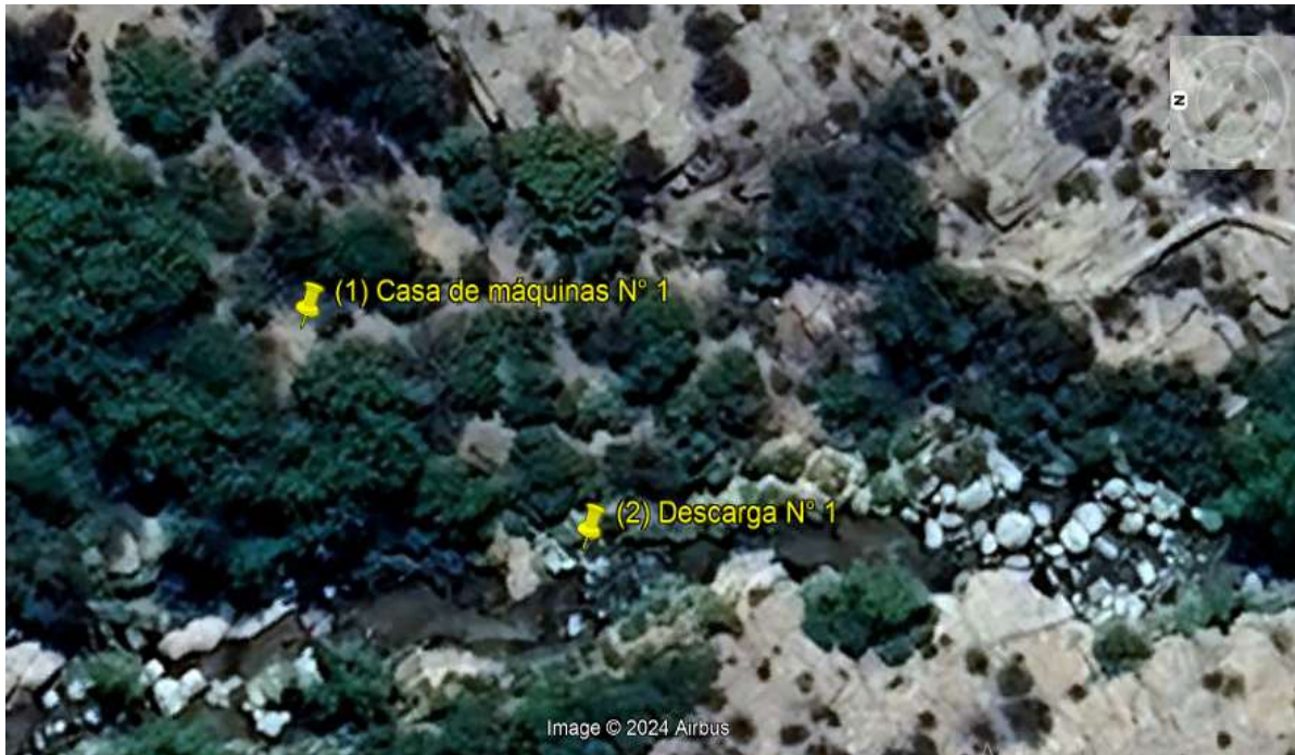
Figura 56 B: Propuesta de emplazamiento de Casa de Máquinas N° 1 y punto de descarga respectivo. (1) Propuesta de localización de Casa de Máquinas N° 1; (2) Propuesta de punto de descarga N° 1. (Google Earth Pro, Modificado).
