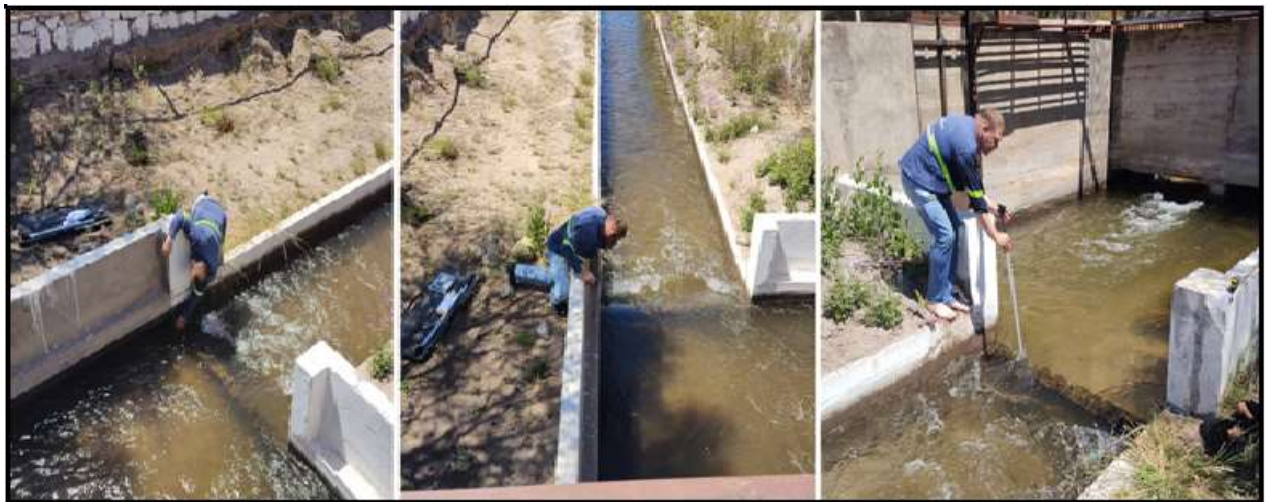
Figura 34: Mediciones sobre el vertedero de medición del Azud Paso de los Sauces. 14 de noviembre del año 2022.
