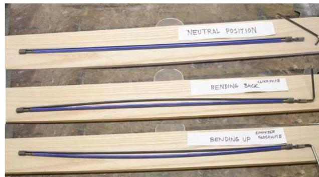
Existen dos tipos de alma: aquellas que son de acción simple y las almas de doble acción. Un alma de acción simple permite contrarrestar la tensión de las cuerdas, sin embargo, en ciertas ocasiones el rango de ajuste es inadecuado para su óptima operación. Por otro lado, las almas de doble acción, como las mostradas en la figura anterior, ofrecen una mayor libertad de ajuste, sin dejar de brindarle rigidez al mástil.
