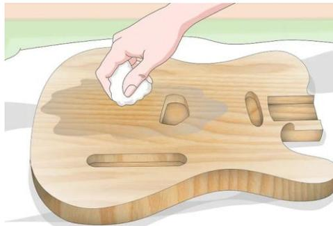
Luego se deja secar por 1 hora y se vuelve a realizar otra aplicación. Se van a realizar un total de 3 aplicaciones. Una vez terminada las aplicaciones, la madera se tornará más oscura.
