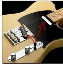
3. Con el selector en el centro, se activan las dos pastillas en paralelo, aflorando un sonido compensado, y con el característico sonido.
