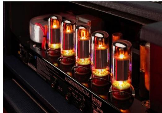
interpreta el instrumento, el amplificador produce un tono más distorsionado cuando las cuerdas son atacadas con una intensidad alta y un tono más suave y cálido cuando son atacadas con una intensidad suave. Por la naturaleza de su construcción requieren mayor mantenimiento que los amplificadores digitales o transistorizados ya que por ejemplo las válvulas poseen una vida útil y son susceptibles al polvo, humedad y temperatura.
