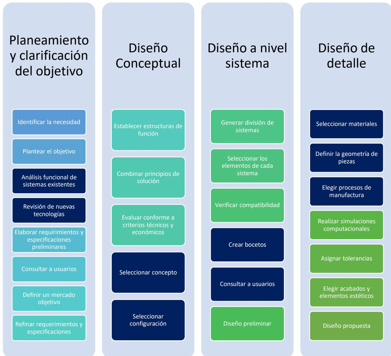
Es importante mencionar que se trata de un proceso cíclico, de manera que al llevar a cabo el diseño se regresó a etapas previas en varias ocasiones para afinar detalles y utilizar la información recabada.
