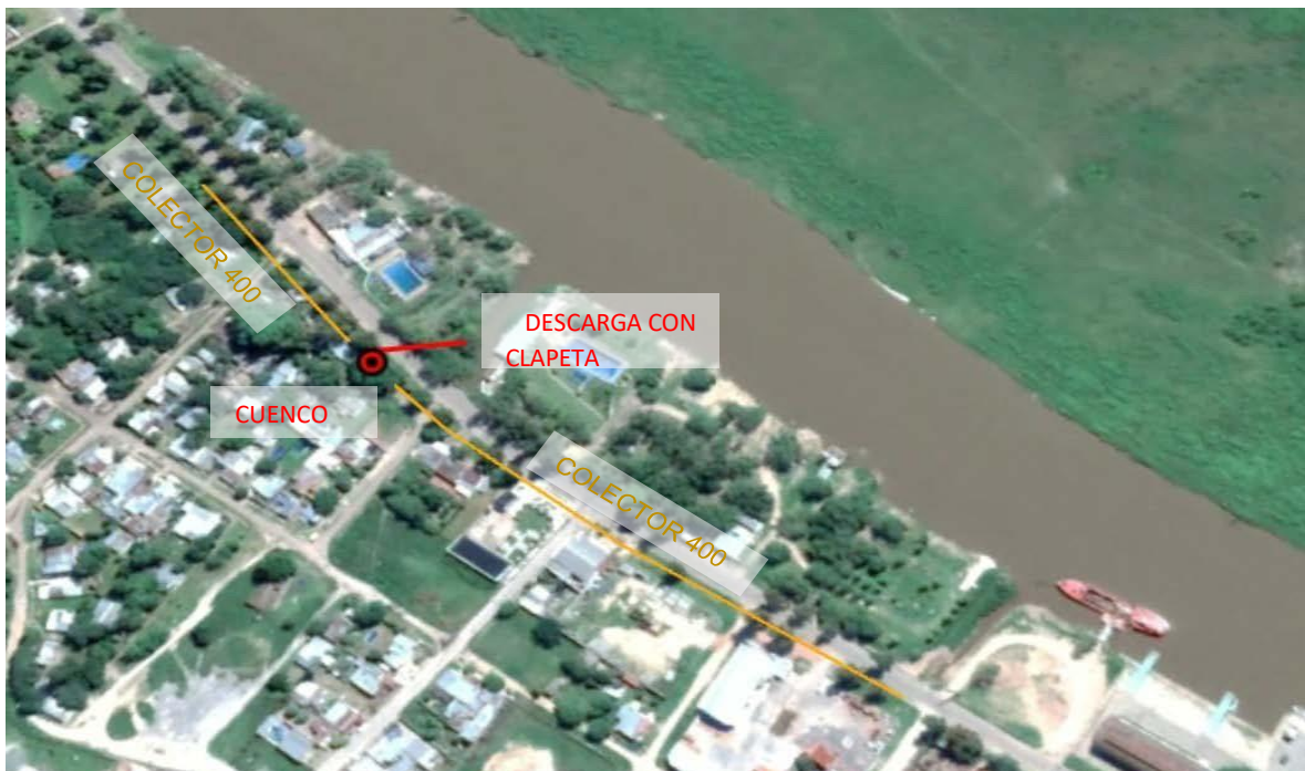
Figura 9. Detalle del cuenco de bombeo centro (proyecto 4.2).
