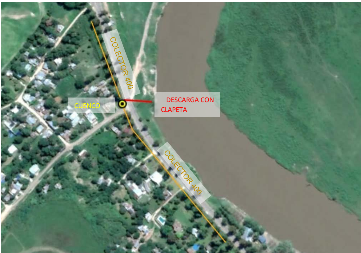
Figura 8. Detalle del cuenco de bombeo oeste (proyecto 4.1).
