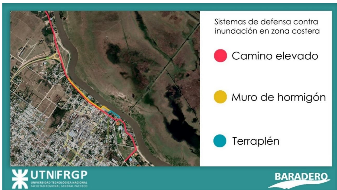
Ilustración 12 - Obras existentes contra la inundación. Fuente: propia
