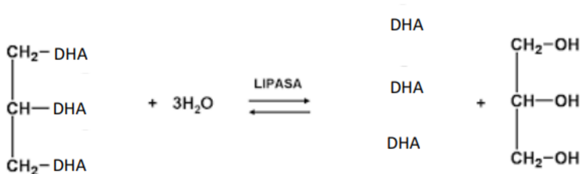
Ilustración 14: Reacción de hidrólisis del aceite de anchoveta obteniendo DHA. Fuente: Universidad Europea.
