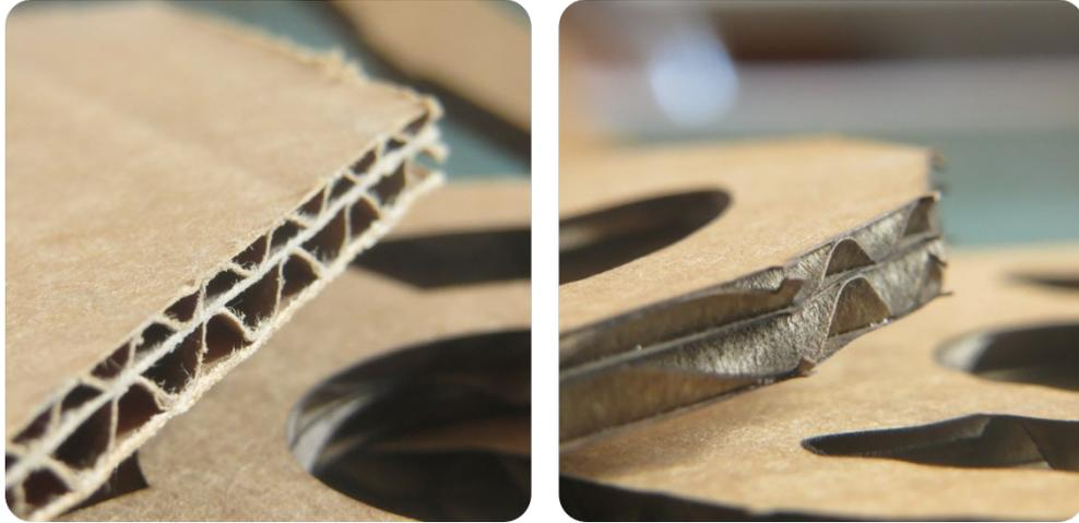
Figura 28. Detalle de bordes cortados con la máquina (izquierda) y con corte láser (derecha)
