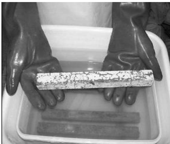
Figura 4: Fisuración en la barra de mortero
