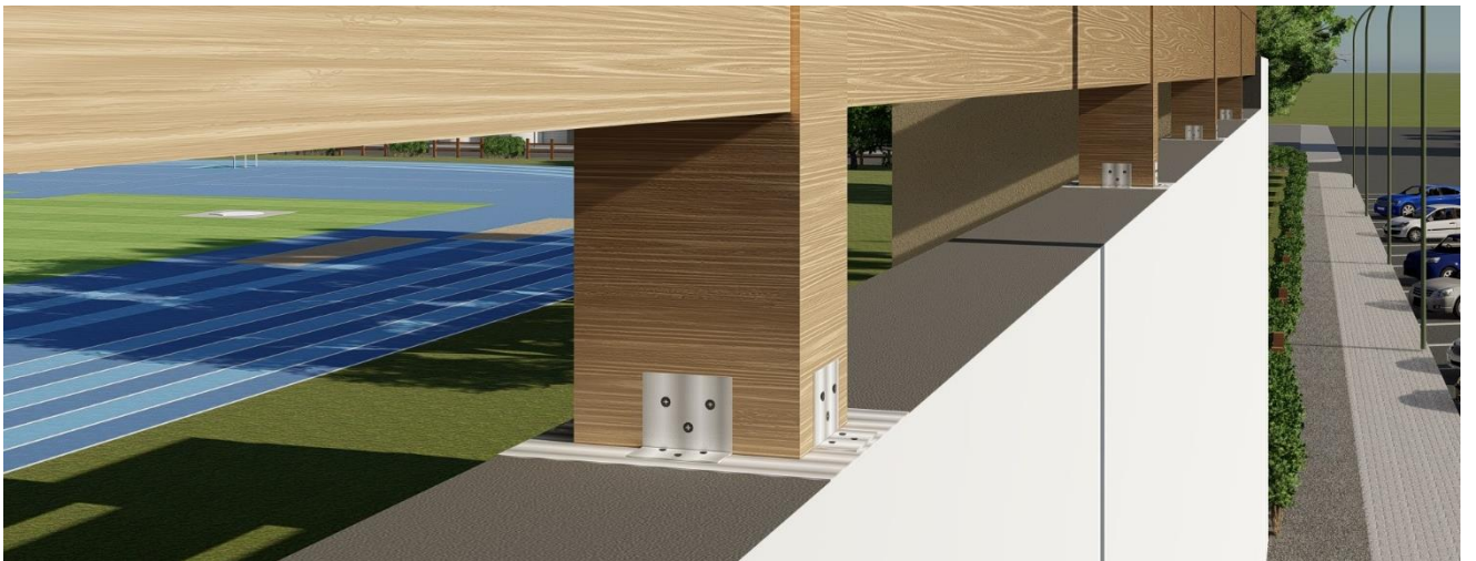
Imagen 84: Uniones en estructura de madera de la cubierta Fuente: Elaboración propia
