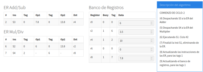
Figura 4: Captura de pantalla de la aplicación, donde se puede apreciar la estación de reserva de suma/resta, estación de reserva de multiplicación/división y el estado del banco de registros
