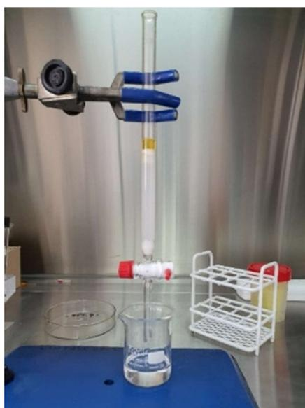
**Figura 7.** Cromatografía en columna de una de las muestras de crudo.
