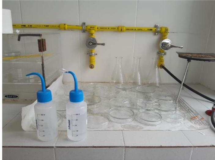
Figura 12: Material de vidrio lavado para ser esterilizado.
