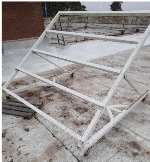
Figura 2. Plataforma ajustable para ensayos de paneles fotovoltaicos.
