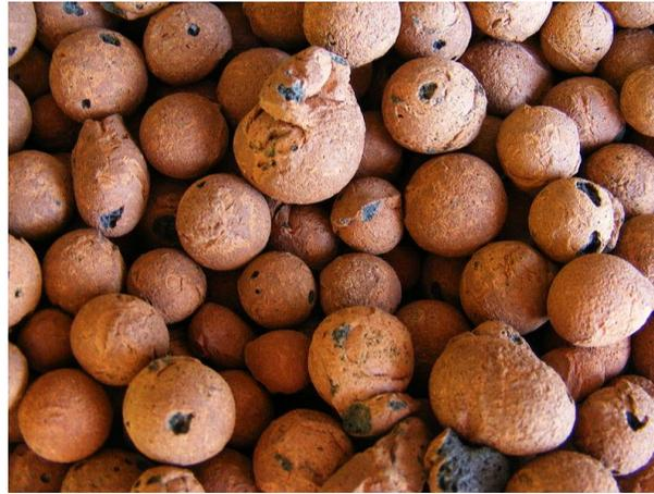
Figura 24: Aislante mineral – Arcilla expandida.
