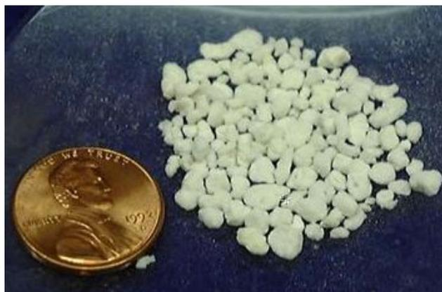
Figura 28: Aislante sintético – Perlita expandida.
