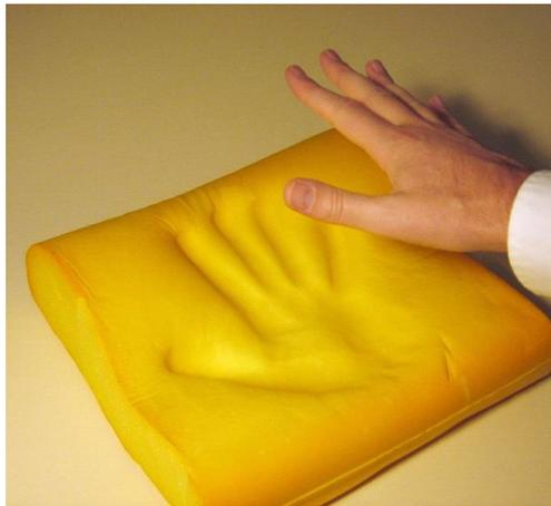
Figura 25: Aislante sintético – Espuma de PVC.
