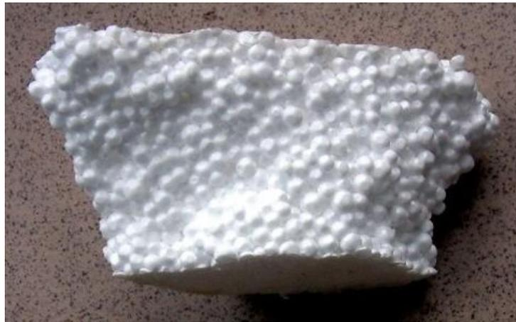
Figura 26: Aislante sintético – Poliestireno expandido.
