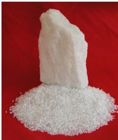
Figura 15: Óxido de aluminio usado como adsorbente.
