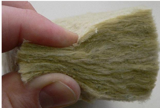
Figura 23: Aislante mineral – Lana de roca.
