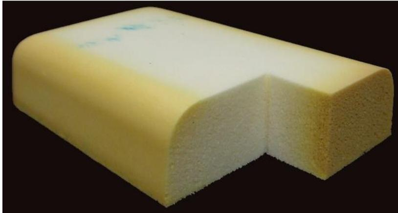
Figura 27: Aislante sintético – Espuma de poliuretano.
