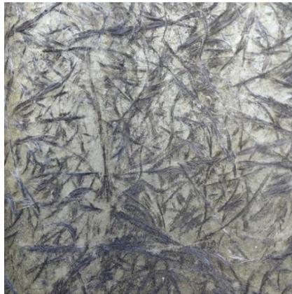
Figura 22: Aislante mineral – Fibra de vidrio.
