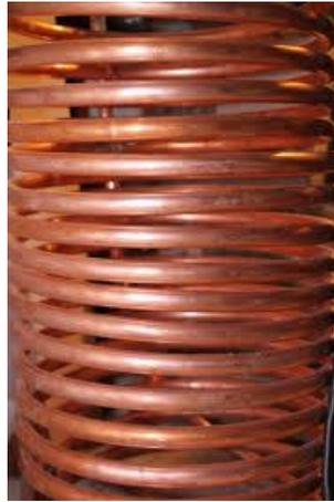
Figura 29: Intercambiador de calor de tubos helicoidal.
