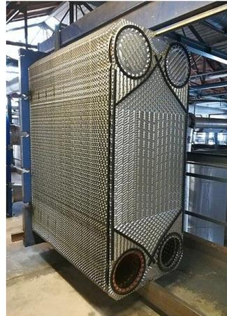
Figura 33: Intercambiador de calor de placas con juntas de estanqueidad.
