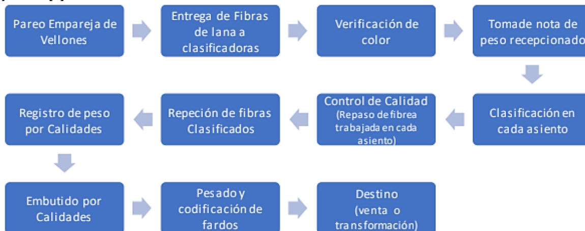
Figura 8: Diagrama del proceso de clasificación de la fibra [4]
