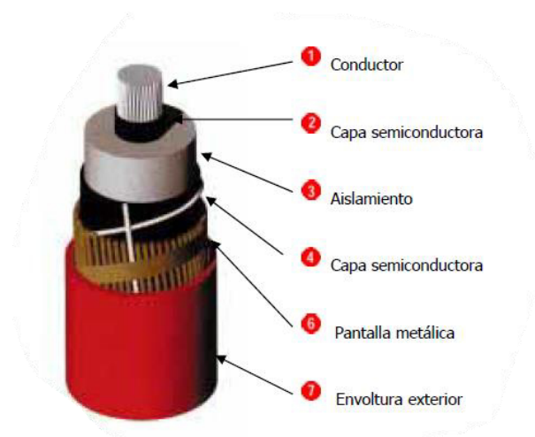
Fig. 21: componentes cable de media tensión
