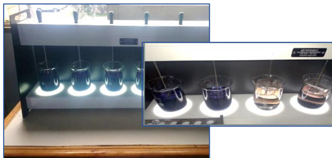
Fig. 2. Reactores usados en los exp. Fenton
