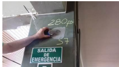
Figura 13: Ensayo de pull off en alguno de los sectores asignados.
