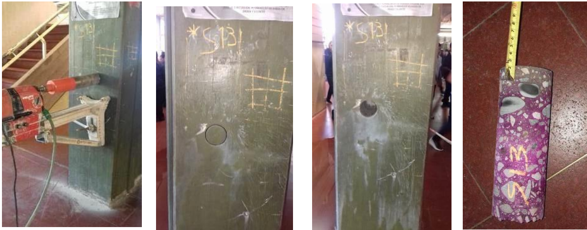
Figura 10: Secuencia de extracción en columnas de uno de los testigos.
