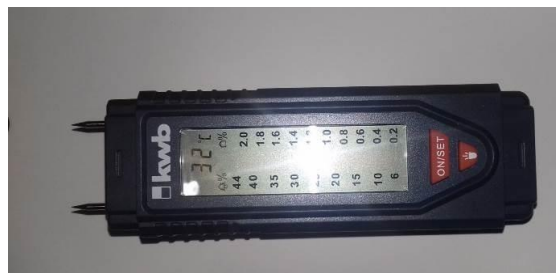
Figura 8: Equipo utilizado en la detección de humedad.
